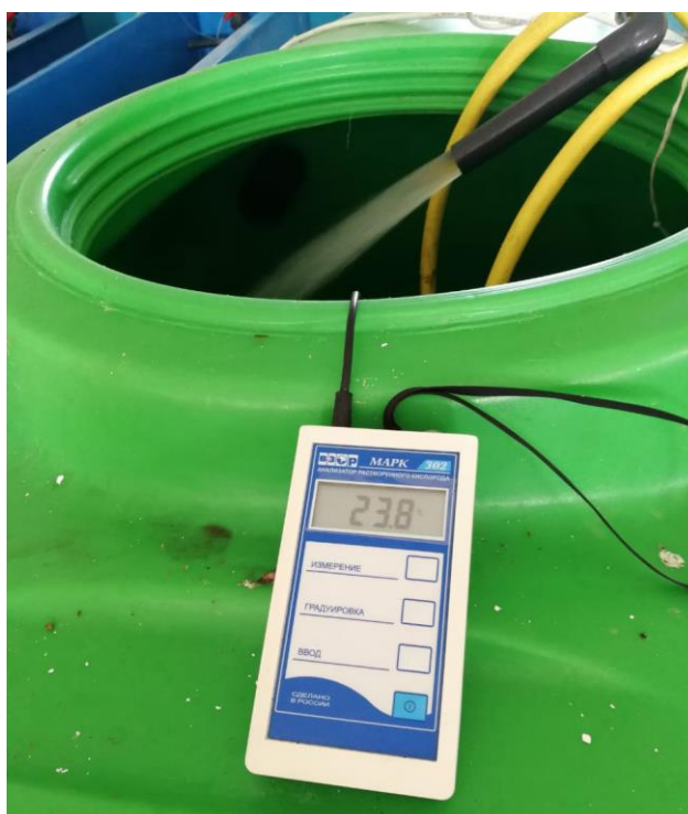
Сурет 11 - Кларий жайыны мен тилапия өсірілген судың гидрохимиялық көрсеткіштерін МАРК-302Э термооксиметрімен анықтау
